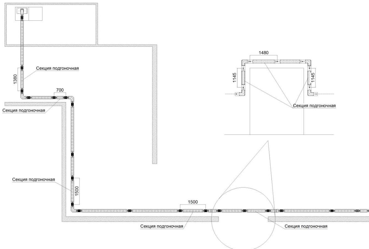
2.1) Если трасса не является шинным мостом, т.е. не связывает между собой трансформатор и шкаф РУНН или два шкафа РУНН, то не забудьте установить на конце трассы шинпровода крышку торцовую (заглушку). Это жизненно необходимо, чтобы в цеху был источник незапланированной катастрофы в виде оголенных концов шин, находящихся под напряжением и способных за секунду испарить человека при касании.
