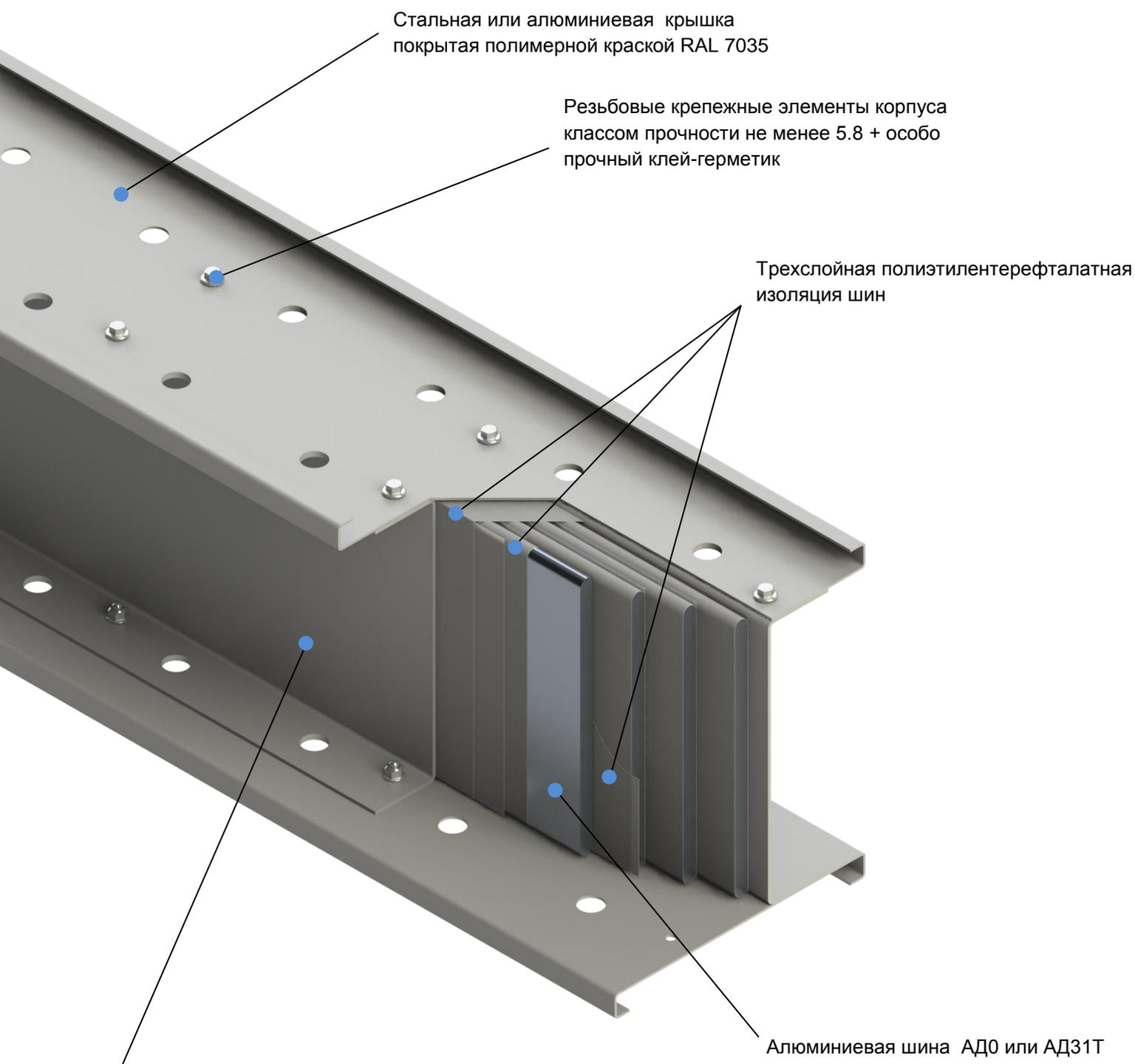
Алюминиевая или стальная боковина в зависимости от исполнения шинопровода покрытая полимерной краской RAL 7035
