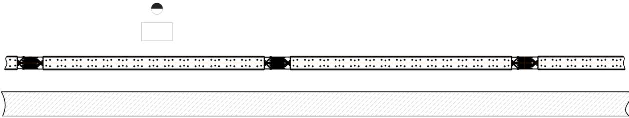
Если смонтировать коробку ответвительную в имеющихся стыках, то это приведет к тому, что потребуется дополнительное удлинение кабельной линии от коробки до конечного потребителя. И ладно если это кабель ВВГнг 5х16, который относительно легок. А если это будет кабель 5х120? для такого кабеля придется придумывать дополнительные поддерживающие конструкции, если его сразу нельзя опустить и пустить по полу в защитном коробе.
