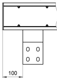
3) Располагать секцию присоединительную к трансформатору над трансформатором следует на расстоянии 150 мм. Это минимальный размер, обусловленный минимальной длиной связей гибких (стр. 70) для подключения шинпровода к трансформатору.
